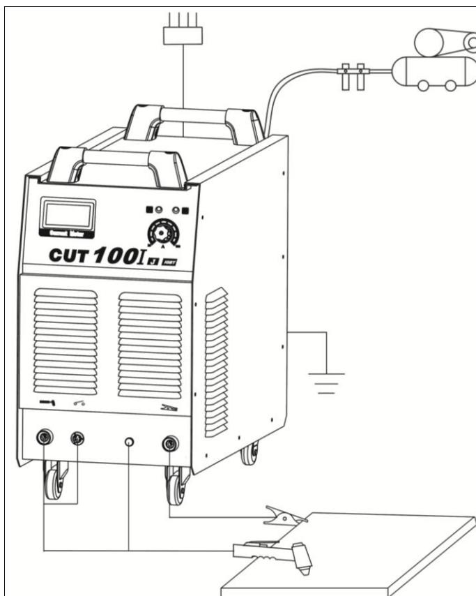
9. Подсоедините шланг подачи сжатого воздуха к входному разъему на редукторе.
